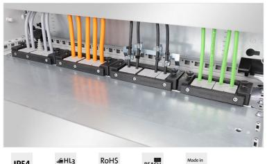
Il KDR-ESR è una piastra brevettata che si installa sul fondo dei quadri per il passaggio dei cavi. Le tasche per l'inserimento a scatto dei listelli KEL-U e KEL-QUICK sono già premontate. Dopo aver inserito i cavi nelle strutture KEL-U queste vengono facilmente e velocemente inserite a scatto nelle tasche del KDR-ESR. In caso di manutenzione, i listelli KEL-U vengono rimossi dalle tasche senza l'ausilio di attrezzi.
